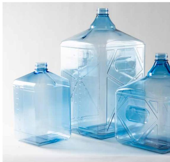
Polycarbonat (PC) ist das am meisten verwendete Material bei der Wasserflaschen-Herstellung für Gebinde über 10 Liter. Dies liegt an den hohen mechanischen Material-Eigenschaften zur Artikelstabilität, der Reinigungstauglichkeit auch bei Temperaturen über 85° C und der glasklaren Transparenz.
