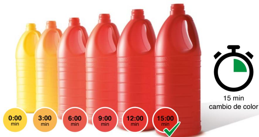
Buscamos áreas con velocidades de flujo y de corte bajas, las llamadas regiones de aguas retenidas o zonas muertas. De esta forma, se mejora específicamente la geometría en todas las áreas del cabezal de extrusión a nivel local. Una evaluación múltiple de los cálculos de los tiempos de permanencia puede mejorar notablemente la respuesta de barrido.
